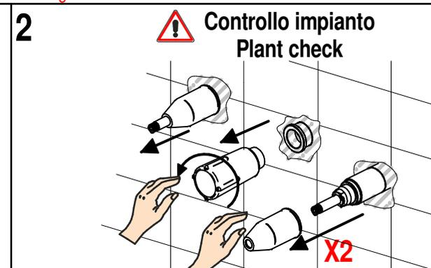
**Per installatore: Al fine di garantire la durata del prodotto installare rubinetti con filtro da pulire periodicamente. Effettuare risciacquo delle tubazioni prima di installare il prodotto (PUNTO 1). Eventuali residui se finissero all'interno della cartuccia potrebbero causarne il danneggiamento**
